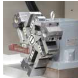
6-fach Werkzeugrevolver (serienmäßig)
