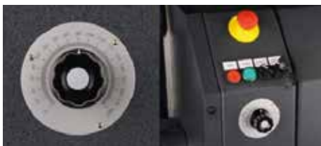
Inklusive manueller Winkeleinstellung mittels Potenziometer
